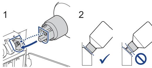
5. Quando è nella posizione corretta, il flacone si sostiene da solo e l'inchiostro riempie il serbatoio automaticamente.
