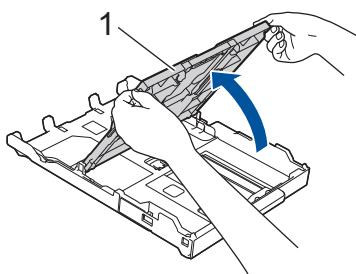
4. Caricare fino a 10 buste nel vassoio carta, con la superficie di stampa **rivolta verso il basso**. Il caricamento di una quantità di buste superiore a 10 può causare inceppamenti.
