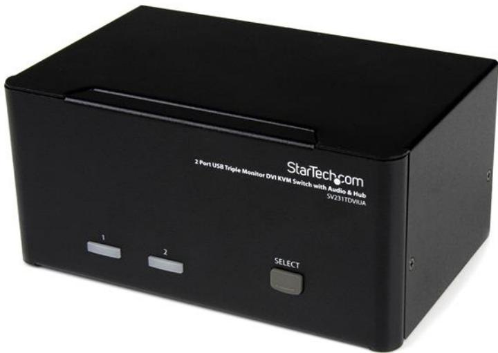
Lo switch KVM DVI USB monitor triplo a due porte SV231TDVIUA consente a 2 PC, dotati ognuno di 3 uscite video DVI, di condividere monitor, un microfono e un set di altoparlanti, una tastiera e un mouse, nonché un'altra periferica USB 2.0, come un disco rigido esterno, un'unità thumb, una stampante o una webcam.
