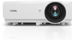
BenQ SH753P. Luminosità proiettore: 5000 ANSI lumen, Tecnologia di proiezione: DLP, Risoluzione nativa del proiettore: 1080p (1920x1080). Tipo di sorgente luminosa: Lampada, Durata della sorgente luminosa: 2500 h, Durata della sorgente luminosa (modalità risparmio): 3500 h. Lunghezza focale: 20.7 - 31.05 mm, Range di apertura (F-F): 2.42 - 2.97, Rapporto di proiezione: 1.39 - 2.09. Modalità colore video: Presentazione, Vivace. Tipo interfaccia seriale: RS-232
