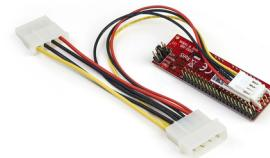
StarTech.com Adattatore per dischi rigidi IDE a SATA o lettori ottici - Convertitore PATA a 40 pin a HDD/SSD/ODD SATA da 2,5" (IDE2SAT2)
