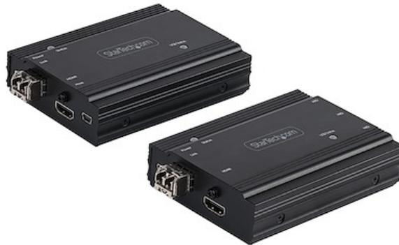
Questo kit extender KVM HDMI consente di utilizzare una tastiera, un mouse e un monitor per controllare in remoto qualsiasi computer su una connessione point-to-point. Insieme a uno switch KVM, l'extender console KVM è utilizzabile con più computer. È dotato di tre porte HID USB che consentono di collegare i dispositivi HID, come la tastiera e il mouse.
