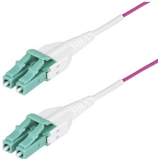
Questo cavo patch in fibra ottica duplex multimodale da LC a LC OM4 offre una connettività affidabile su reti da 40 e 100 Gigabit. La guaina viola erica conforme a TIA distingue chiaramente il cablaggio OM4 da quello verde acqua OM3, eliminando le incertezze nelle configurazioni di rete. Il design compatto del connettore uniboot consente un facile inserimento e rimozione in installazioni ad alta densità.
