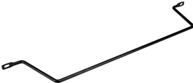
Queste barre di allacciamento si installano orizzontalmente sulla parte anteriore o posteriore del rack per fornire un punto di fissaggio sicuro per gestire i cavi; questi vanno fissati alle barre di allacciamento con fascette per cavi per ridurre la tensione su di essi e impedire di danneggiare le porte sull'apparecchiatura con montaggio a rack. Le barre di allacciamento presentano un distanziale di 10 cm per un comodo accesso ai cavi.
