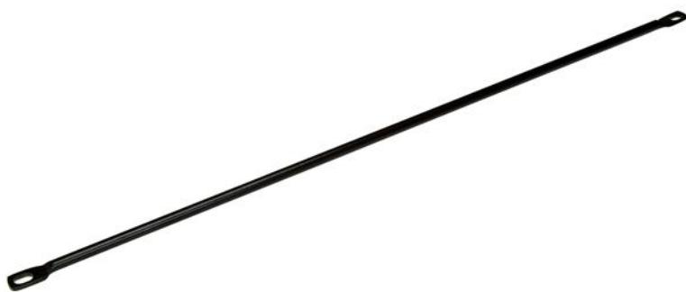
Queste barre di allacciamento si installano orizzontalmente sulla parte anteriore o posteriore del rack per fornire un punto di fissaggio sicuro per gestire i cavi; questi vanno fissati alle barre di allacciamento con fascette per cavi per ridurre la tensione su di essi e impedire di danneggiare le porte sull'apparecchiatura con montaggio a rack.
